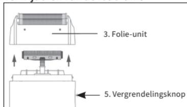
Druk op de vergrendelingsknop (5) aan de zijkant van het scheerapparaat, pak de folie-unit (3) aan beide kanten vast en trek deze voorzichtig omhoog.
