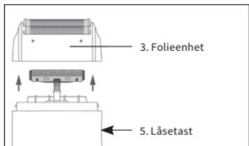
Trykk på låsetasten (5) på siden av barbermaskinen, ta tak i folieenheten (3) på begge sider og trekk den forsiktig oppover.
