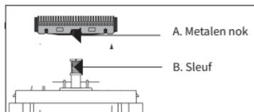
Trimmer losmaken: aan beide kanten vastpakken en omhoog trekken.
