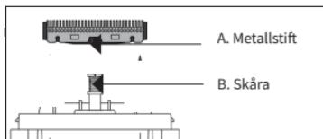
Lossa lamellknivarna: Ta tag på båda sidorna och dra dem uppåt.
