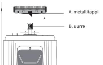
Lamelliterän irrottaminen: Tartu molemmilta puolilta kiinni ja vedä ylös.
