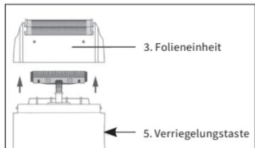
Drücken Sie die Verriegelungstaste (5) seitlich am Rasierer, fassen Sie die Folieneinheit (3) an beiden Seiten und ziehen Sie diese sanft nach oben.
