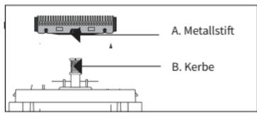
Lamellenmesser lösen: An beiden Seiten anfassen und hochziehen.
