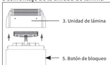
Pulse el botón de bloqueo (5) situado en el lateral de la afeitadora; sujeté la unidad de lámina (3) por ambos lados y tire suavemente de ella hacia arriba.
